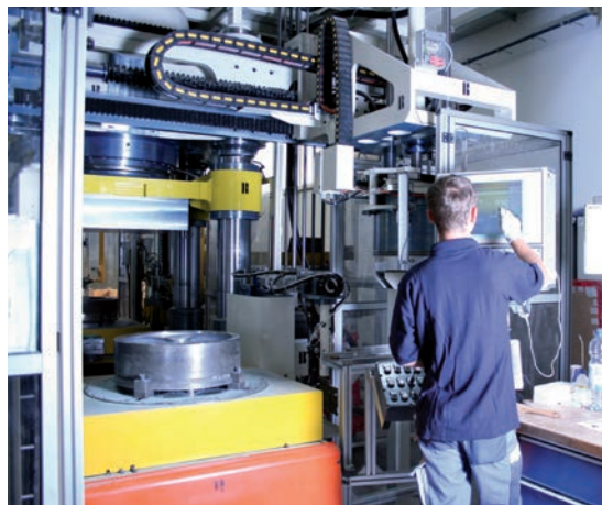
CNC-weggesteuerte Pressen zur wiederholbaren Einhaltung der homogenen Scheibenstruktur.
