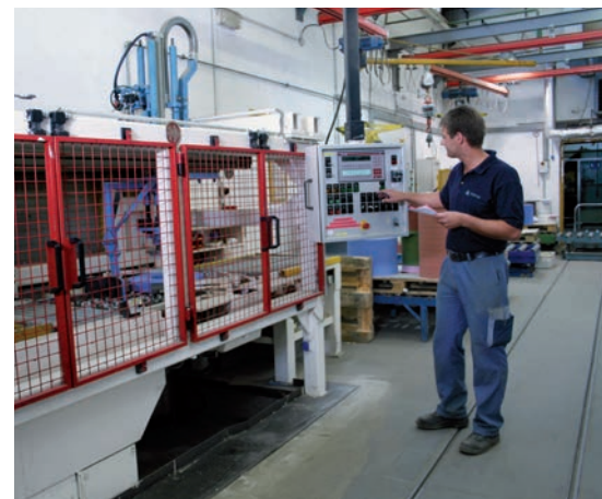
Computergesteuerte Prüfmaschinen zur Unwuchtkontrolle und für Probelaufgeschwindigkeitstests.
