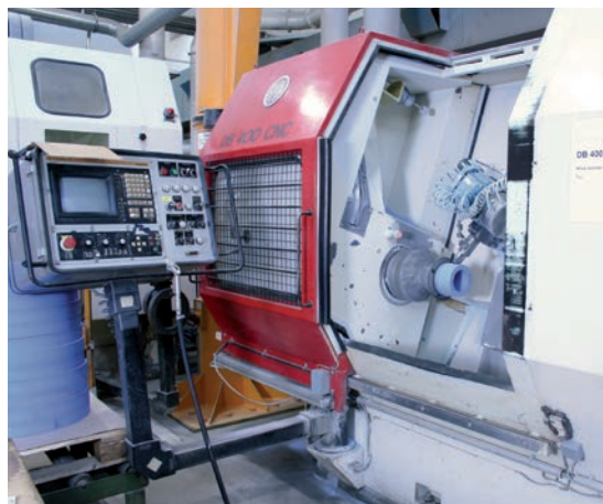
CNC-gesteuerte Drehmaschinen zur genauen Endbearbeitung.
