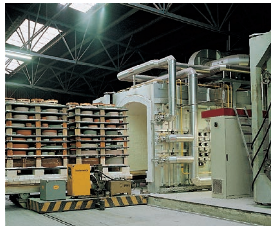
Öfen mit elektronischer Steuerung der Brennkurve für wiederholbare und dokumentierte Qualität.
